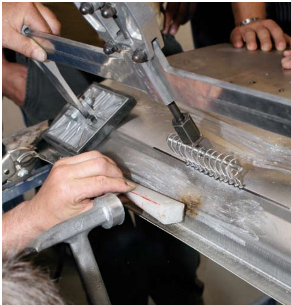
Kunststoffkeil und leichte Hammerschläge geben der Delle den Rest. Unter ständiger Vorspannung der Zugbrücke gleicht die Reparatur einem Kinderspiel
