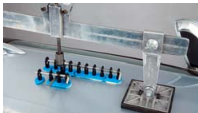
Stark auf dem Vormarsch ist die Klebetechnik, bei der statt geschweißter Metall-Bits unterschiedlich ausgeformte, weiche Kunststoff-Pads an die beschädigte Stelle geklebt werden. Die Technik eignet sich ideal für das schnelle Richten von deformierten runden Flächen.
