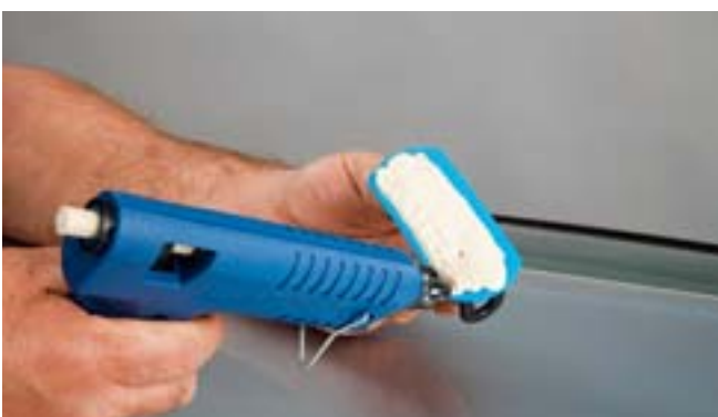
Stark auf dem Vormarsch ist die Klebetechnik, bei der statt geschweißter Metall-Bits unterschiedlich ausgeformte, weiche Kunststoff-Pads an die beschädigte Stelle geklebt werden. Die Technik eignet sich ideal für das schnelle Richten von deformierten runden Flächen.
