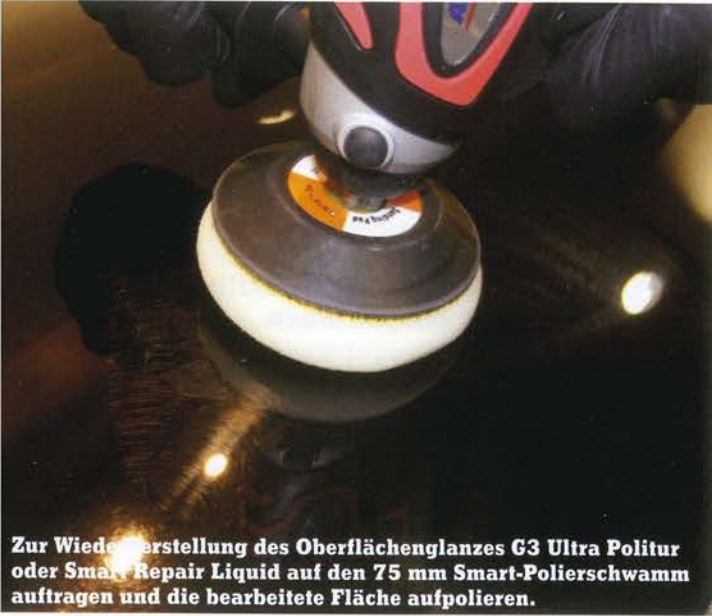
Für den optimalen Glanz einen zweiten Polierdurchgang mit der 75 mm Mini-Poliermaschine und dem Smart Polierschwamm durchführen. Abschließend die Oberfläche mit dem Mikrofaser Tuch abwischen.
