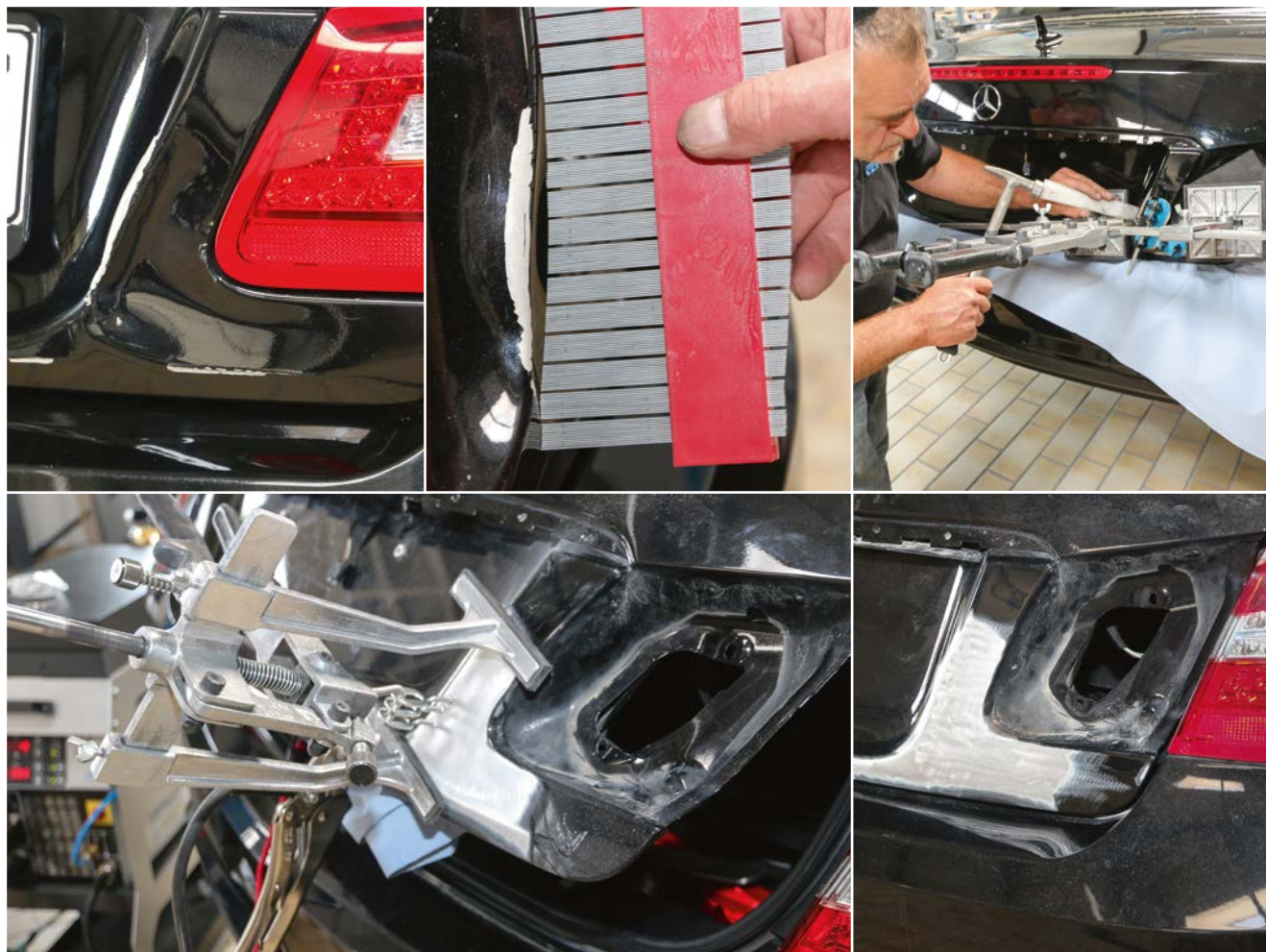
Aluminium-Anbauteile, wie diese Mercedes-Heckklappe, werden häufig teuer ersetzt, obwohl eine Reparatur ökologisch, technisch und wirtschaftlich sinnvoll wäre. Das einzigartige Miracle AluRepair-System sorgt – analog zum Richten von Stahlblechen mit dem Miracle-Reparaturkonzept – für eine schnelle und kostensparende Instandsetzung.
