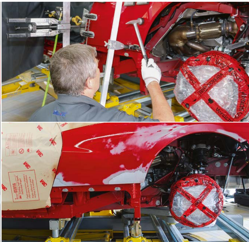
Wirtschaftlich und technisch sinn-, aber auch anspruchsvoll: Die fachgerechte Instandsetzung von großflächigen Schäden an Aluminium-Karosseriebauteilen ist nur mit Miracle AluRepair machbar.
