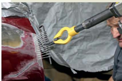
Der Joker bei doppelwandigen Aluminium-Außenhautstrukturen: Miracle AluRepair. Hier wurde eine Seitenwand an einem Jaguar Cabrio instandgesetzt.
