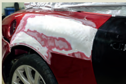
Der Joker bei doppelwandigen Aluminium-Außenhautstrukturen: Miracle AluRepair. Hier wurde eine Seitenwand an einem Jaguar Cabrio instandgesetzt.
