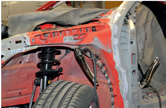
Der zu ersetzende Aluminium-Gussknoten reicht vom unteren Ansatz des Schwellers nach vorne zum Federbeindom und bis zum oberen Dachansatz.
