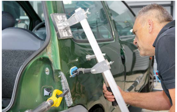
Großflächige und diffizile Seitenwandschäden gestalten sich durch Instandsetzung deutlich günstiger als beim Austrennen und Einschweißen von Neuteilen. Damit bleiben vermeintliche Totalschäden auch bei älteren Fahrzeugen noch machbar und wirtschaftlich.
