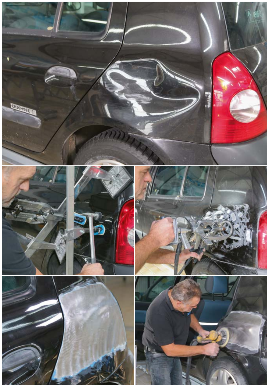
Eigentlich ein klarer Austausch Kandidat: Berücksichtigt man das Alter des Fahrzeugs, ist es fast schon ein wirtschaftlicher Totalschaden. Doch mit der Miracle-Klebertechnik konnten mehr als 90 Prozent der Deformation schnell beseitigt werden.
