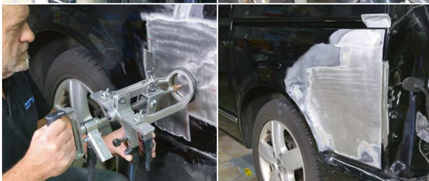
Der Austausch der Seitenwand an dem VW Multivan (Baureihe T5) wäre ein massiver Eingriff in die Fahrzeugstruktur gewesen. Für Carbon-Techniker Klaus Luz gehören solche Reparaturen mittlerweile zum Tagesgeschäft.
