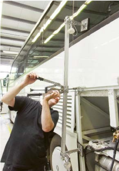
Reparatur von Dellen an Beplankungen mit Miracle-Zugwerkzeugen wie dem Line-Puller ohne aufwendige Demontage von Bauteilen.
