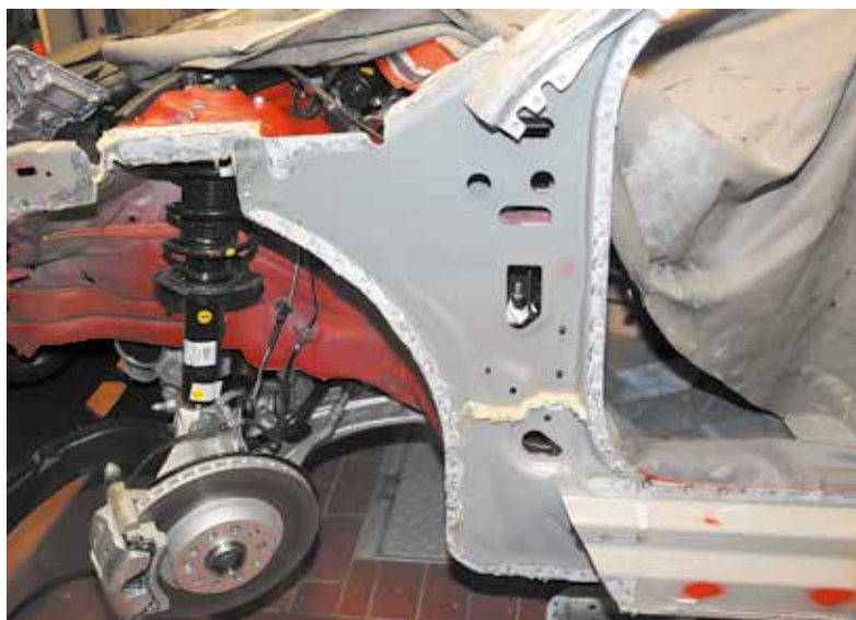
Für den Austausch des Gussknotens an der A-Säule des Fahrzeugs müssen über 70 Stanznietverbindungen gelöst werden, viele davon an doppelwandigen Bereichen. Die Zeitersparnis durch das Ziehen der Nieten ist immens.
