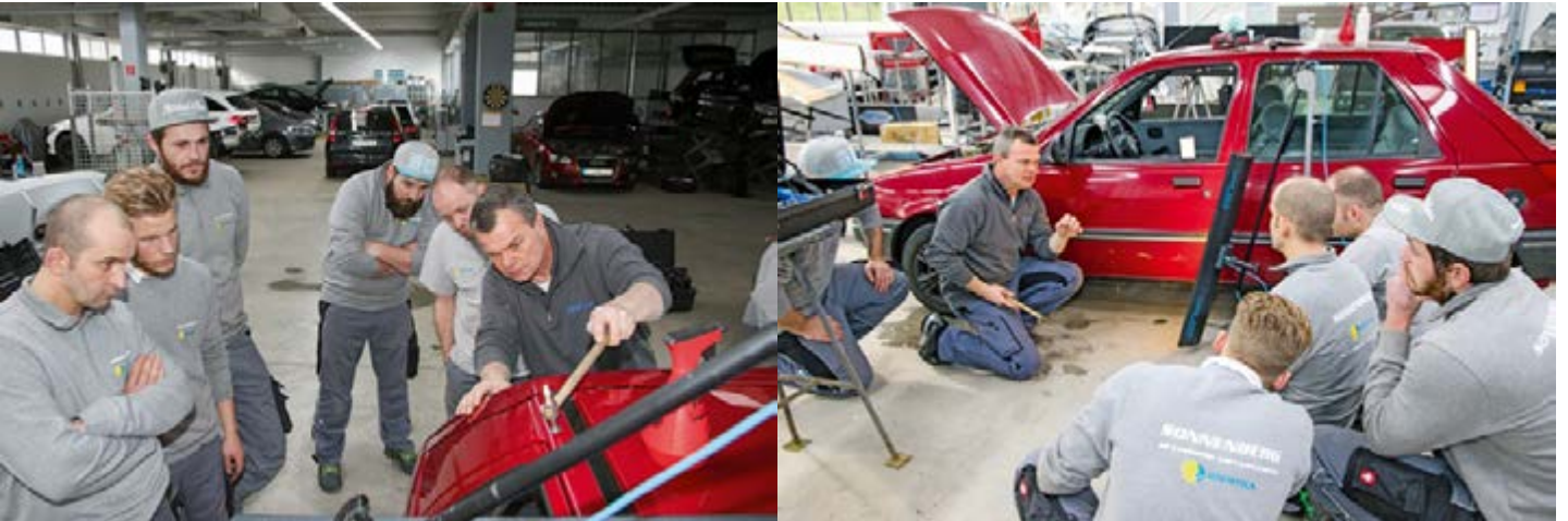
Schlechte Zugänglichkeit für Hebel im Dachbereich: Karosserietrainer Thomas Beck erklärt die AOL Klebetechnik.
