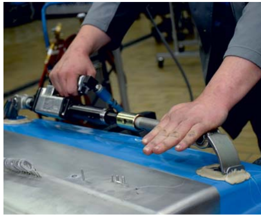
Mit der Airo-Power-Druckluftpresse bringt der Profi verformte Blechteile wieder auf die ursprüngliche Länge.
