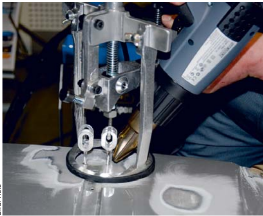
Die einstellbare Heißluftpistole erleichtert es, die optimale Temperatur einzuhalten.
