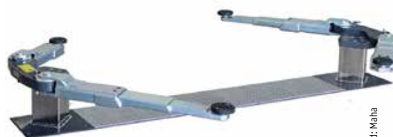
Die charakteristische Vierkantverkleidung der Hubstempel schützt die Hydraulikzylinder vor Funkenflug und bewirkt eine hohe Verdrehsteifigkeit der ZS-Square-Baureihe von Maha.
