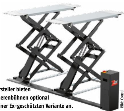
Die charakteristische Vierkantverkleidung der Hubstempel schützt die Hydraulikzylinder vor Funkenflug und bewirkt eine hohe Verdrehsteifigkeit der ZS-Square-Baureihe von Maha.
