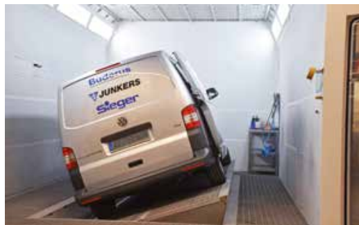
Das Fahrzeug wird auf der Power Stage zur Seite geneigt – so hat der Lackierer auch im Schwellerbereich einen optimalen Lackauftragswinkel.
