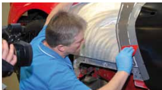
Richard Wolfrum von Carbon trug den Schwemmmzinersatz von Henkel auf den Ferrari auf. Er beschleunigte die Trocknung des Materials mittels eines IR-Trockners.
