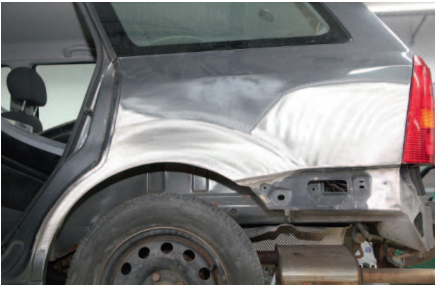
Auch bei älteren Fahrzeugen lohnt sich zum Beispiel eine solche Instandsetzung der Seitenwand, da die Kosten für einen Komplettersatz oft den Wiederbeschaffungswert übersteigen würden.
