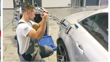
Perfekte Instandsetzung an einer Seitenwand / Radlauf ohne Austausch der beschädigten Teile mit dem Miracle-Reparaturkonzept von Carbon.
