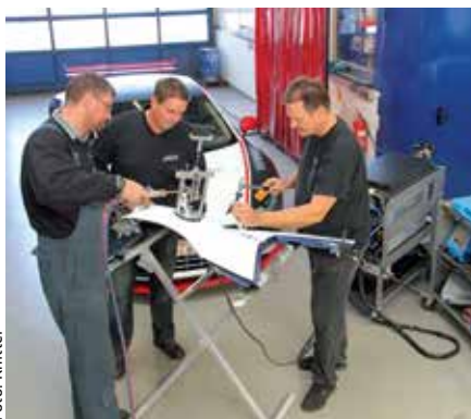
Reparatur eines Audi-R8-Seitenteils aus Aluminium gemeinsam mit Carbon-Trainer Klaus Dollas.
