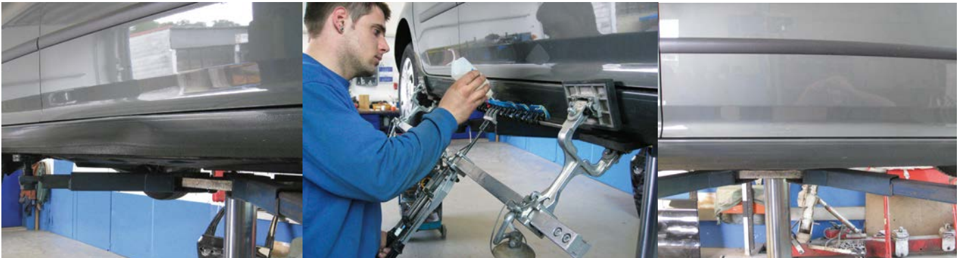
Typischer Schwellerschaden: Mit Hilfe von aufgeklebten Pads und der Miracle-Technik in diesem Fall sogar komplett ohne nachträgliche Steinschutz-Strukturanpassung und Lackierung rückgeformt.
