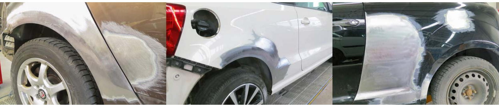
Schadensbilder und gleichzeitig Paradebeispiele für Miracle-Reparaturen: Speziell bei Schäden an verschweißten Teilen wie Schweller und Seitenwand ermöglicht das Reparatursystem qualitativ einwandfreie Ergebnisse.
