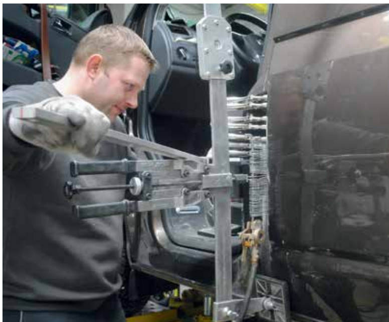
Kanten werden mit aufgeschweißten Bits sauber nachgearbeitet.
