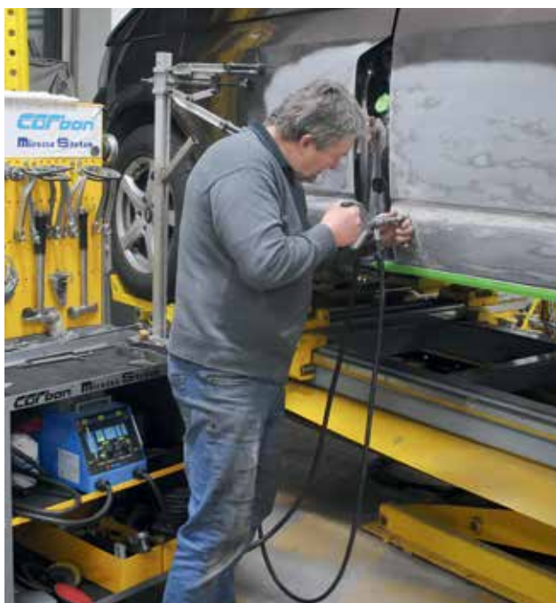
Den Easy-Puller nutzt der Karosseriebauer für die feineren Arbeiten.
