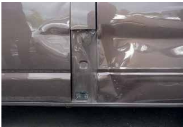
Kniffliger Job: Die Deformation am Camper umfasst die Tür, die B-Säule und das vordere Seitenteil.
