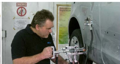
Polo-Seitenwandschaden: Mit dem VAS 6321 der Carbon GmbH ist eine technisch einwandfreie und sehr wirtschaftliche Rückverformung möglich, die ohne Spachtelarbeit gefüllt und lackiert werden kann.
