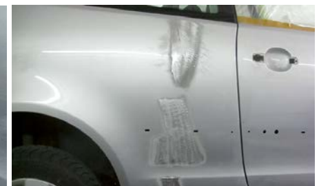
Polo-Seitenwandschaden: Mit dem VAS 6321 der Carbon GmbH ist eine technisch einwandfreie und sehr wirtschaftliche Rückverformung möglich, die ohne Spachtelarbeit gefüllt und lackiert werden kann.
