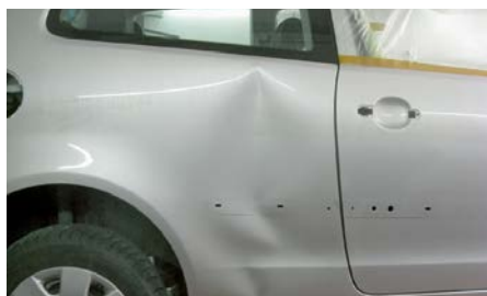
Polo-Seitenwandschaden: Mit dem VAS 6321 der Carbon GmbH ist eine technisch einwandfreie und sehr wirtschaftliche Rückverformung möglich, die ohne Spachtelarbeit gefüllt und lackiert werden kann.
