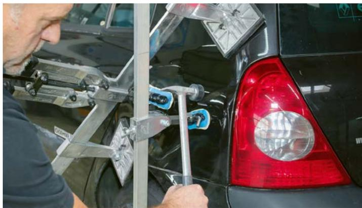
Die verbleibende Restspannung kann durch leichte Schläge mit dem Aluminium-Hammer gelöst werden. Der Rest ist normale Finish-Arbeit.
