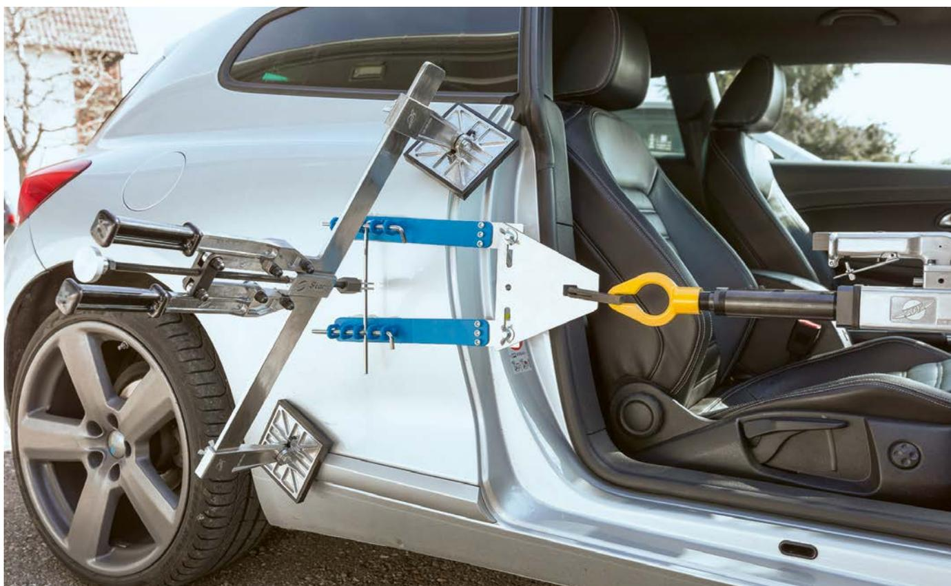
Die völlig neu entwickelte Klebetchnik-„Peitsche“ ermöglicht, bei großen Flächen sehr hohe Zugkräfte exakt zu steuern.
