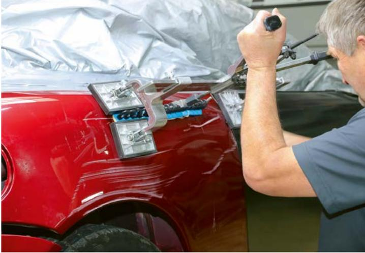
Die Miracle-Klebetchnik ist eine Grundvoraussetzung für effiziente Reparaturen an Aluminium-Außenhautteilen.
