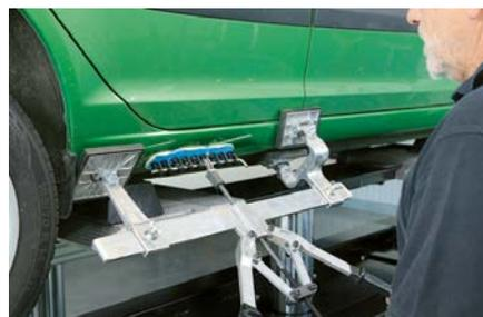
Bei typischen Schwellerschäden bringt die Miracle-Klebetchnik eine Zeitersparnis von über 60 Prozent.
