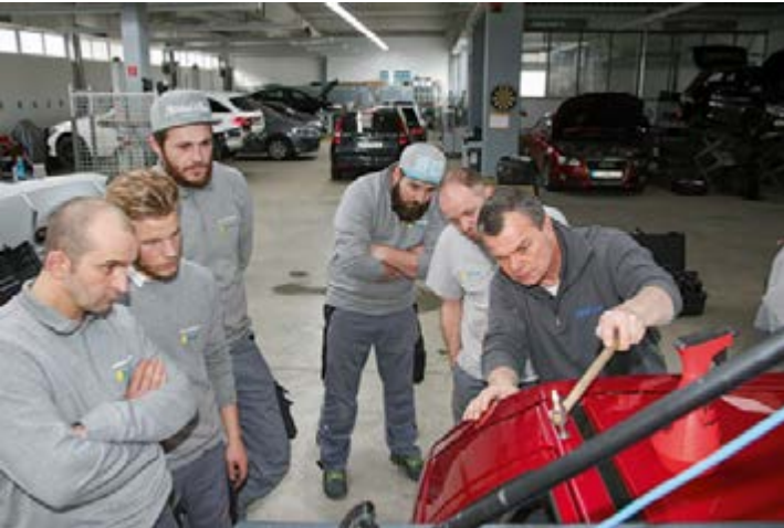
Schlechte Zugänglichkeit für Hebel im Dachbereich: Karosserietrainer Thomas Beck erklärt die AOL Klebetechnik.
