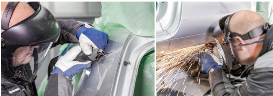
Vom Hersteller vorgegebener Trennschnitt an der C-Säule Auftrennen des hinteren Schwellerfalzes
