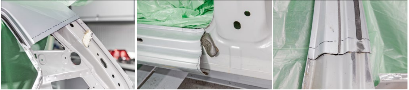
Die drei werkseitig vorgegebenen Trennschnitte an der B- und C-Säule sowie am hinteren Schwellerbereich wurden von Ralf Rathmann korrekt ausgeführt.
