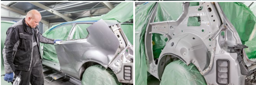
Mit dem Entfernen der Seitenwand ist der erste Reparaturabschnitt geschafft. Wie es jetzt weitergeht, gibt's in vier Wochen live in Potsdam in der eigens dafür aufgebauten Reparaturhalle zu sehen.
